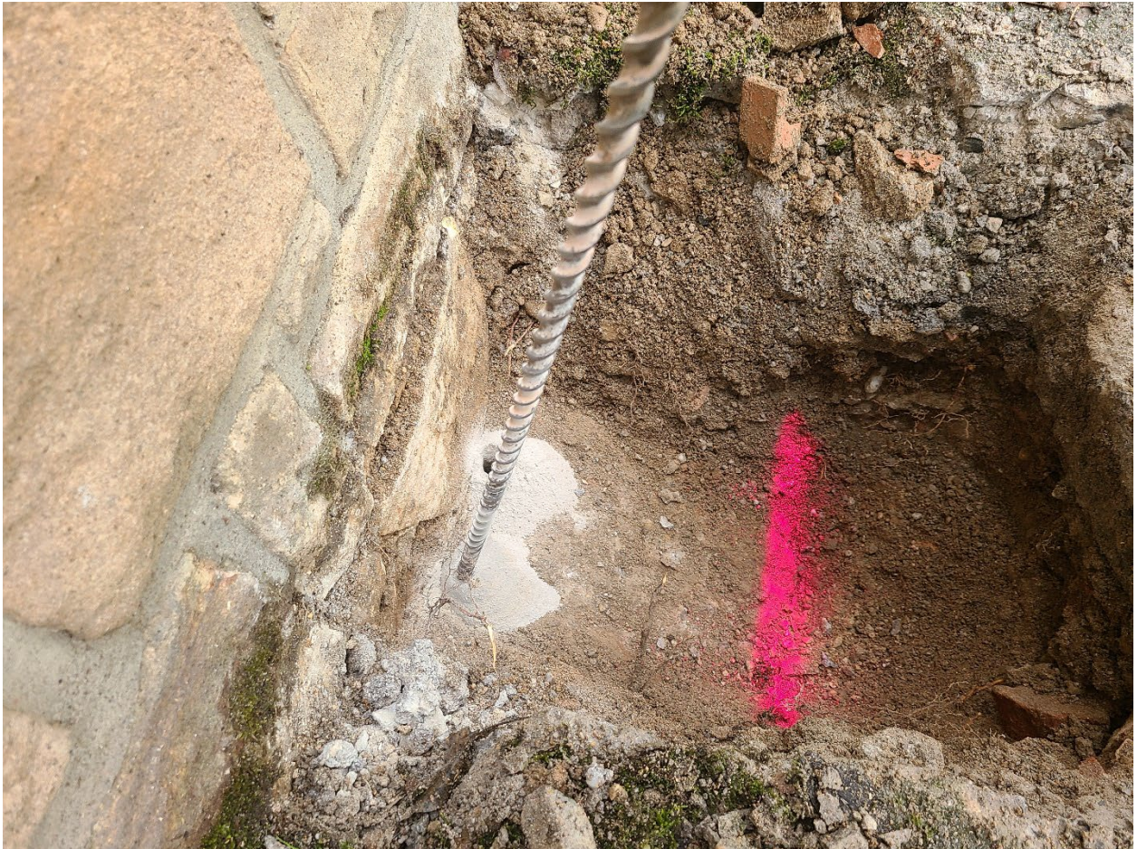
Sondage SM3 réalisé par perçage
